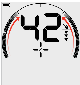
Sinal de alvo fraco/fora do centro: Menos segmentos de discriminação estão ativados. O alvo está localizado mais próximo do exterior da bobina.
